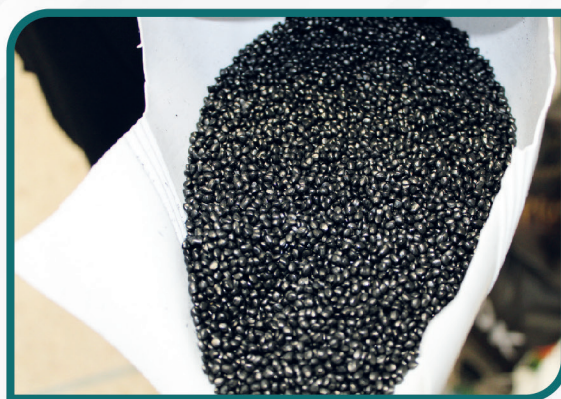
Granulés de plastiques recyclés générés par une unité de recyclage des DPA dans la Région Souss Massa
